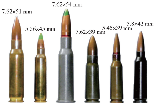
图7 防弹标准中6种常用小口径弹丸形貌对比
