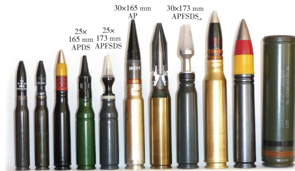
图 4 北约防弹标准 STANAG 4569 中 5 级、6 级防护要求测试弹丸形貌对比
